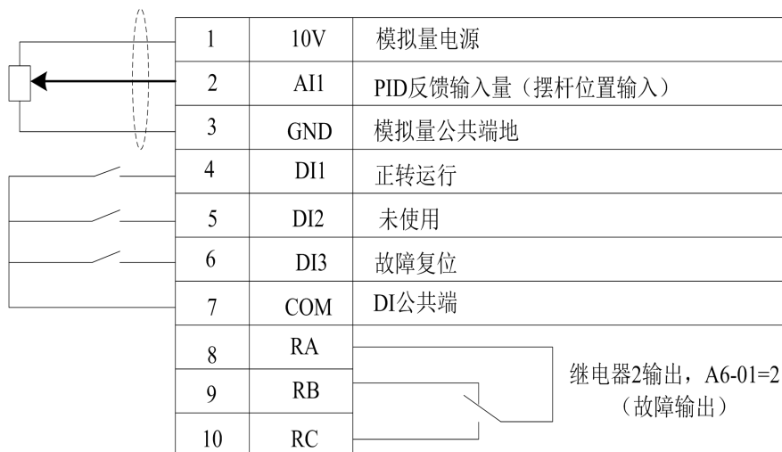
图 5.2 动力放卷接线示意图
