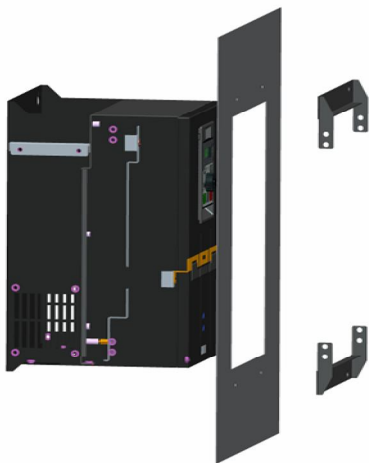
图3-4. A500/A500S变频器钣金结构穿墙式安装图
