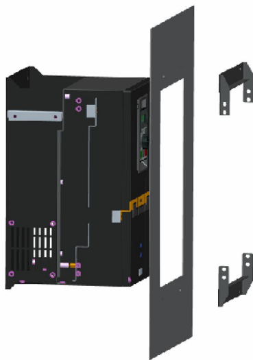
图3-4. A700/A700S变频器钣金结构穿墙式安装图
